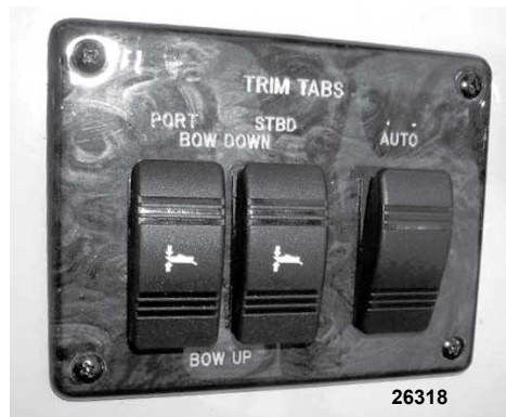
Typische Trimmflossenschalter (automatisch und manuell)
